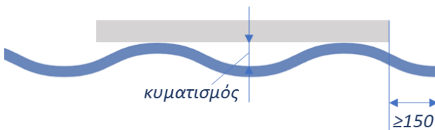
Εικόνα 6 Έλεγχος τοπικών κυματισμών θερμικά κατεργασμένου υαλοπίνακα (EN 12150-1)
